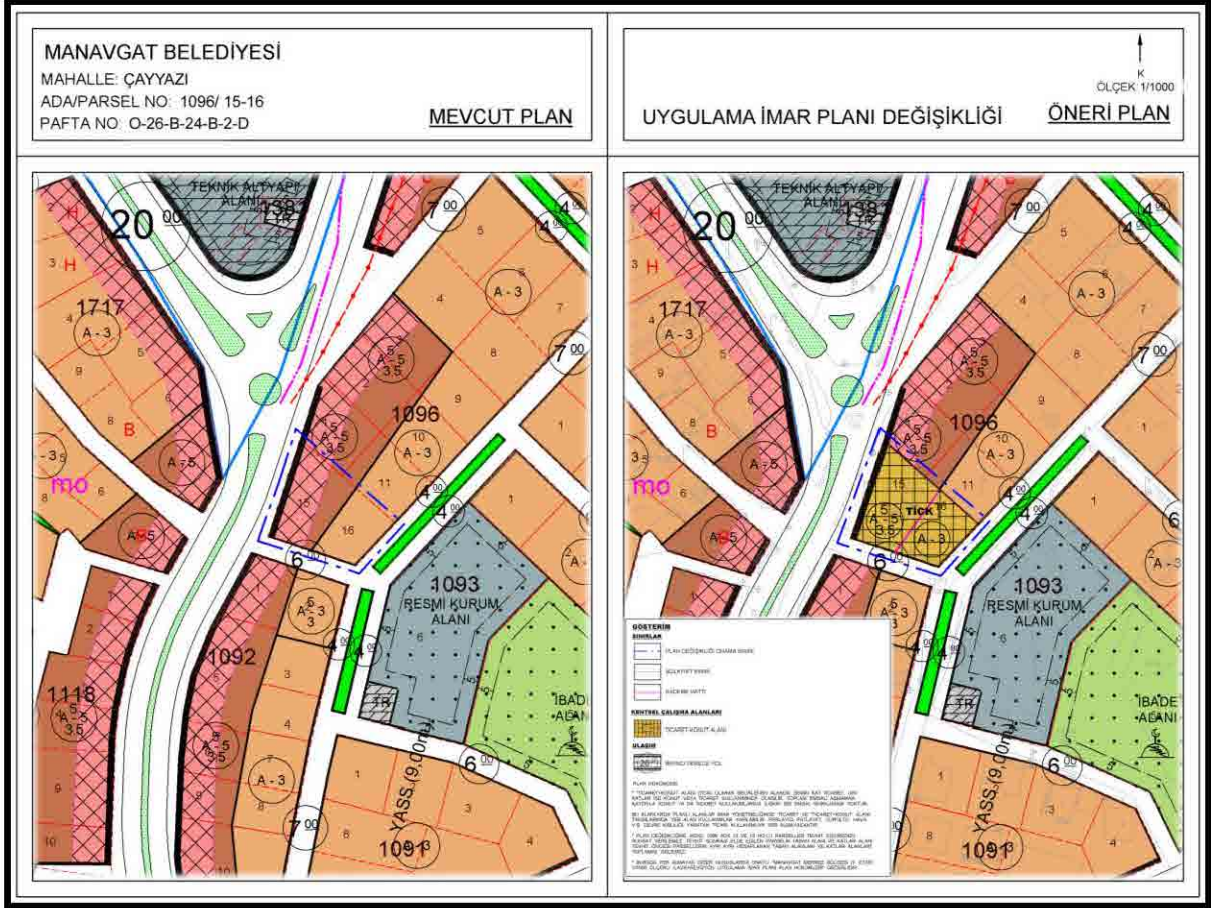
Şekil 4: Mevcut-Öneri Uygulama İmar Planı Örneği
