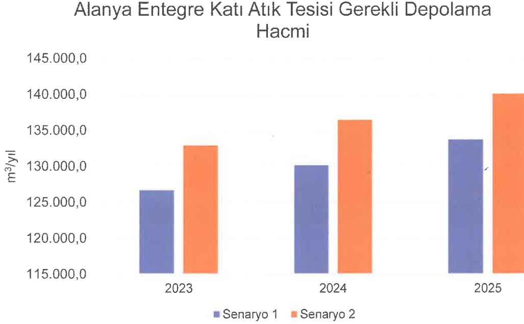
Şekil 8.5 Alanya Entegre Katı Atık Tesisi Senaryo 1 ve Senaryo 2 için gerekli depolama hacimleri
