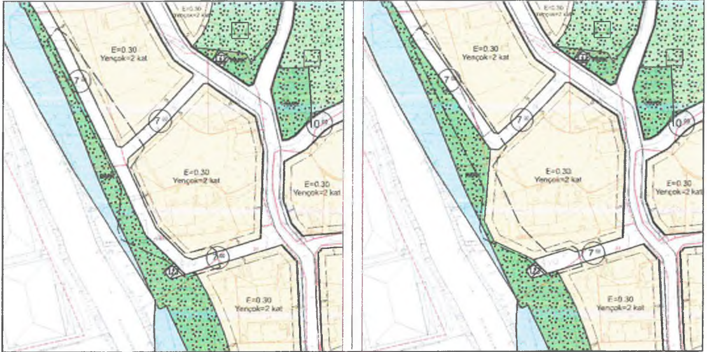
Resim 1: Yolda Kalan Yapılar Nedeniyle Ulaşım Bağlantısında Yapılan Düzenleme
