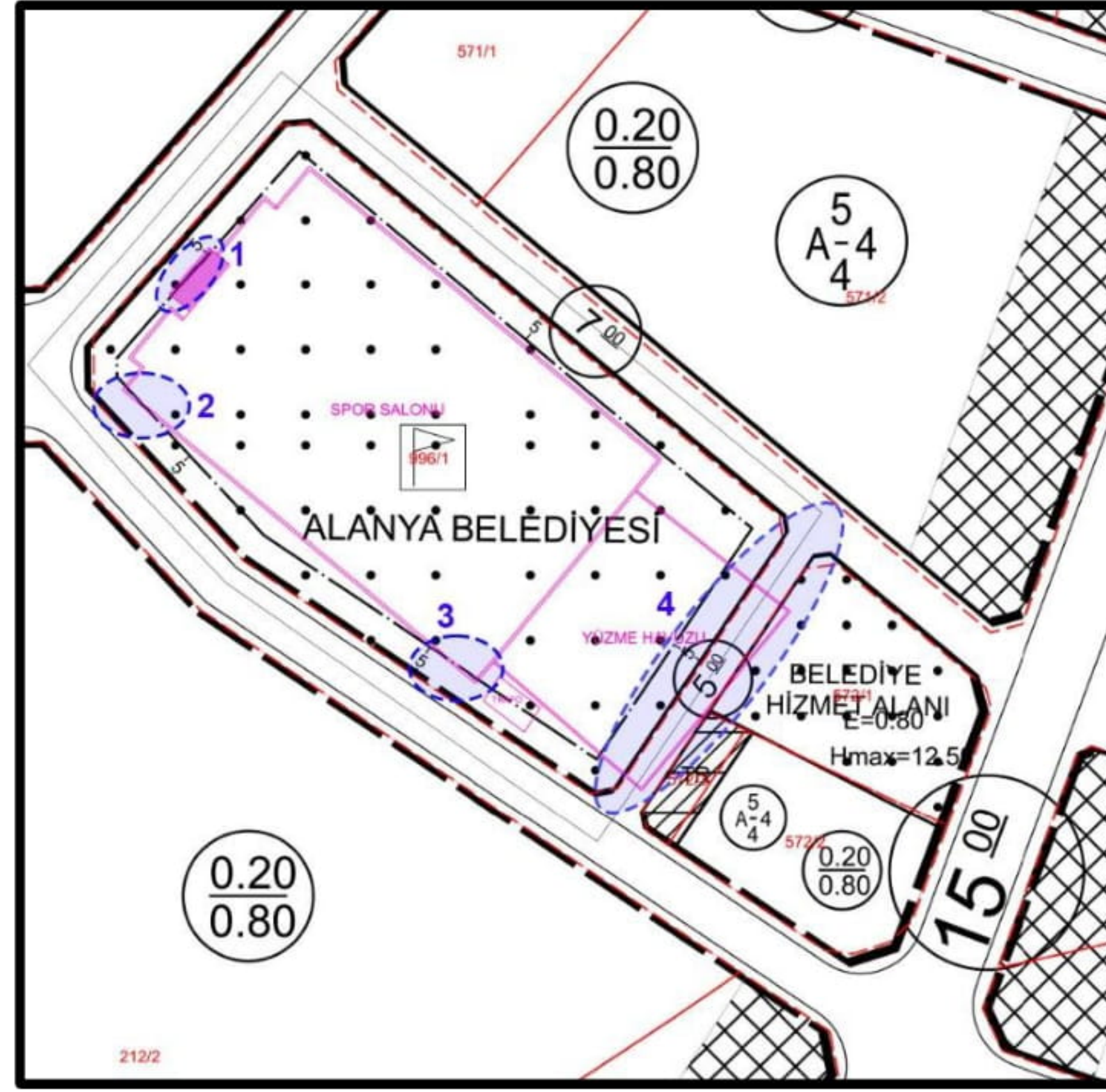
Şekil 8. Arazi incelemeleri sonucunda mimari proje ile imar planı arasında tespit edilen uyumsuzluklar
